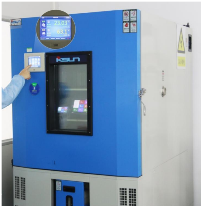
图 4-4 高低温老化测试图
